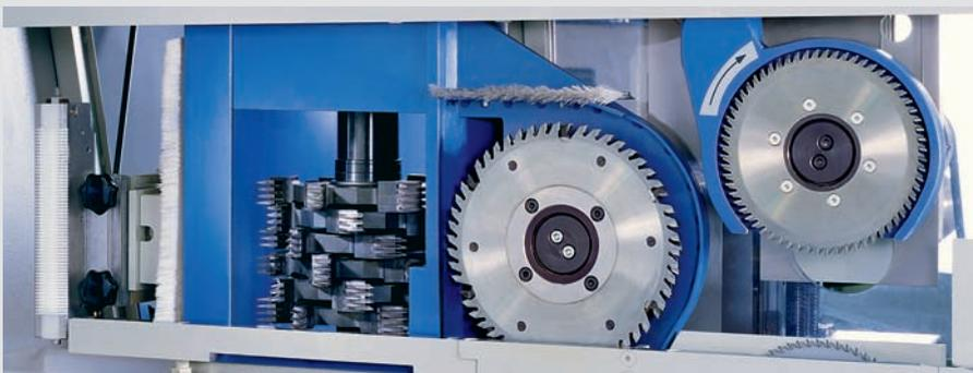
Excelente estándar de herramientas con sierras incisoras desde arriba y abajo, triturador y fresa de fingers para la fabricación de unos perfiles perfectos de ensamble tipo finger joint. Con la ProfiJoint podrá convertir en productos valiosos las maderas cortas de secciones comerciales, incluso aquellas de longitudes cortas.
