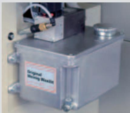
Por regla general, las máquinas de alta velocidad van equipadas con la bomba automática de lubricante. Los intervalos de lubricación los determina usted mediante un relé temporizador que se encuentra en el armario de distribución eléctrica.
