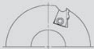
Sujeción de las cuchillas mediante listones de sujeción rápida CentroLock (la sujeción de los listones se realiza por medio de dos tornillos de sujeción laterales).
