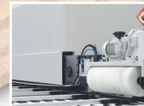
Detail view of the unique pneumatic double top pressure system. Vue détaillée du système presseur supérieur pneumatique double. Detalle del sistema de presión superior neumático doble.
