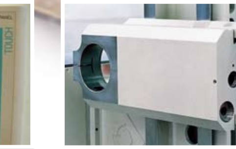
Detail of cast-iron working units mounting slide. Détail de la glissière de support des unités de travail en moulage de fonte. Detalle de las correderas en fundición para las unidades de trabajo.
