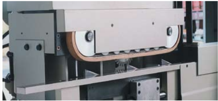
Detail of the feed system and the hold-down system. Détail du système d'avance et du système presseur. Detalle del sistema de avance y del sistema prensor.
