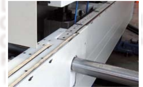
Outfeed crosswise processing motorized belt. Chenille motorisée à la sortie de la machine travaillant la largeur. Cintas motorizadas de expulsión piezas de la máquina para el mecanizado trasversal.
