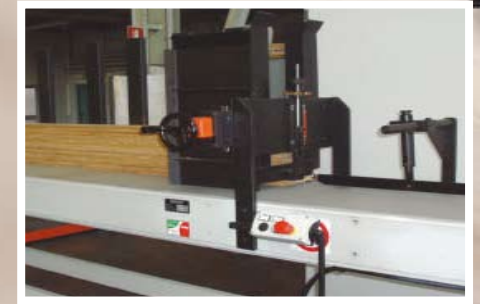
Hopper feeder for lengthwise profiling machine. Chargeur vertical pour fraiseuse travaillant la longueur. Alimentador vertical automático a la entrada de la máquina para el mecanizado longitudinal.
