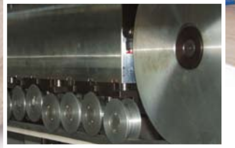
Pneumatic motorized top pressure belt. Chenille presseuse supérieure motorisée. Correas compresoras superiores neumáticas y motorizadas.
