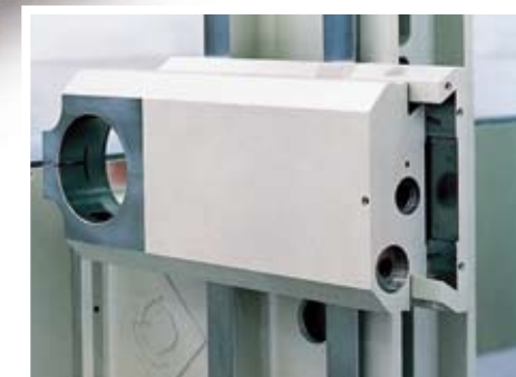
Detail of cast-iron working units mounting slide. Détail de la glissière de support des unités de travail en moulage de fonte. Detalle de las correderas en fundición para las unidades de trabajo.
