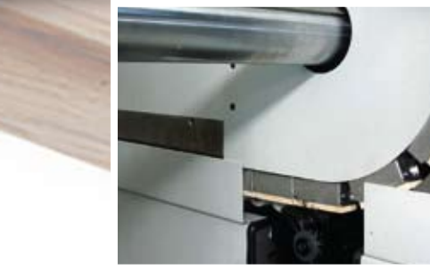
Feed chains cleaning brush. Brosse pour le nettoyage des chaînes d'entraînement. Detalle del cepillo limpiador de las cadenas de avance.
