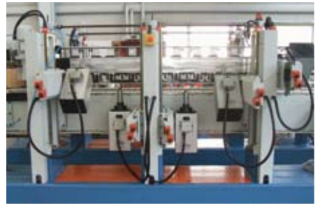
5 + 5 spindle configuration for crosswise processing machine. Configuration 5 + 5 arbres pour machine travaillant la largeur. Configuración de 5+5 ejes para el mecanizado trasversal.
