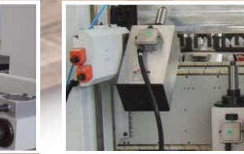
Profiling units with pneumatic top pressure devices. Unités de fraisage avec dispositif presseur supérieur pneumatique. Unidades de fresado con presores neumáticos superiores.
