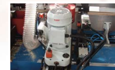
Stazione di profilatura con sistema automatico rompitrucolo. Estación de fresado con sistema automático de rompévtruta. Estação de fresagem com sistema triturador automático.
