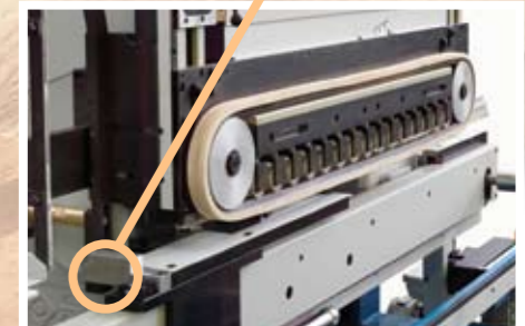
Sistema avanzamento pezzi e sistema pressore con dettaglio della contrasagoma parascheggie.
