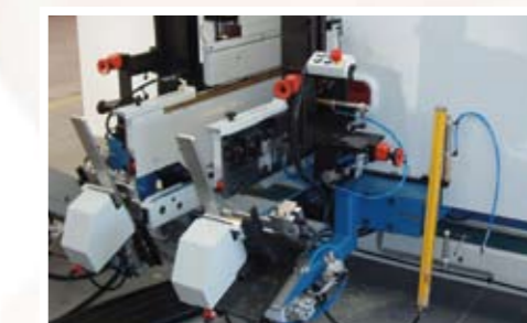
Ritorno pezzi all'operatore con accatatore automatico. Mecanización retorno piezas al operario con apilador automático. Mecanização de retorno das peças ao operário com empilhador automático.
