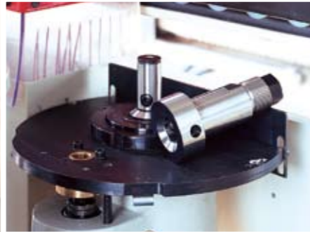
Sistema di cambio rapido manuale dell'utensile.
