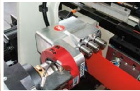
Testina di foratura a 90° con sistema cambio rapido "HSK 63 C".
