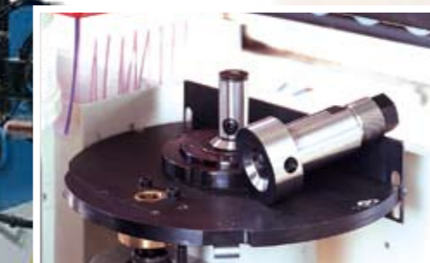
Cambio rapido manuale dell'utensile, mod. "FRIULMAC". Sistema manual de cambio rápido de la herramienta, mod. "FRIULMAC". Sistema manual de troca rápida da ferramenta, mod. "FRIULMAC".
