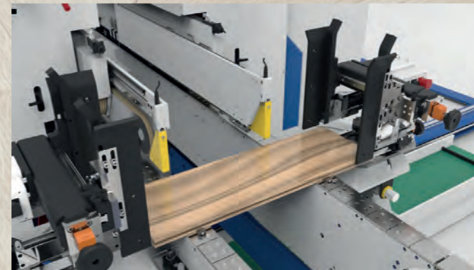
🇮🇹 Caricatore verticale e pressore superiore settati per la lavorazione a 90° 🇫🇷 Chargeur vertical et pousseur supérieur pour l'usinage à 90° 🇪🇸 Cargador vertical y empujador superior para el trabajo a 90°
