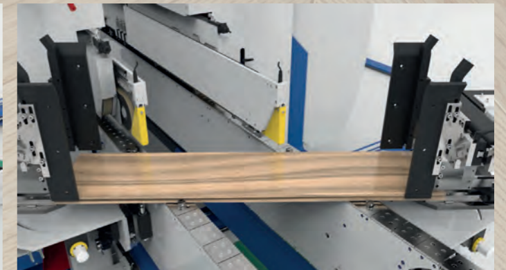
🇮🇹 Caricatore verticale e pressore superiore settati per la lavorazione ad angolo 🇫🇷 Chargeur vertical et pousseur supérieur pour l'usinage à angle 🇪🇸 Cargador vertical y empujador superior para el trabajo a ángulo
