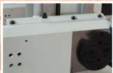
Cast-iron working units mounting slide detail. Détail de la glissière de support des unités de travail en moulage de fonte. Detalle de las correderas en fundición para las unidades de trabajo.
