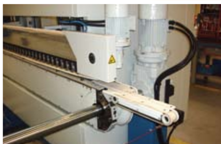
Outfeed crosswise processing motorized belt. Chenille motorisé à la sortie de la machine travaillant transversalement. Cintas motorizadas de expulsión piezas de la máquina para el mecanizado trasversal.
