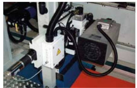
Working unit automatic angular positioning. Positionnement angulaire automatique des unités de travail. Posicionamiento angular automático de las unidades de trabajo.
