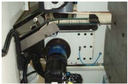
Feeding system by means of brushless motor (electrical axis). Système d'avancement par moteur brushless (axe électrique). Sistema de avance por motor brushless (eje eléctrico).
