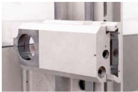
Cast-iron working units mounting slide detail. Détail de la glissière de support des unités de travail en moulage de fonte. Detalle de las correderas en fundición para las unidades de trabajo.
