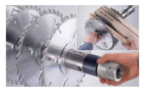
Nunca antes ha cambiado las hojas de sierra tan fácil y cómodo como con el sistema de fijación rápida patentado Quickfix. Y todo ello en un tiempo récord: Aflojar la tensión hidráulica, insertar maderas de muestra. Deslizar las hojas de sierra en el eje, tensar de forma hidráulica. Y listo. Sin casquillos de quita y pon, anillos intermedios ni herramientas.
