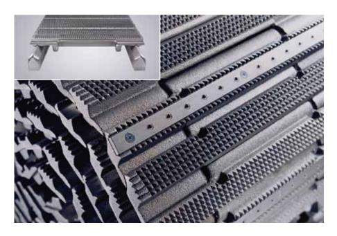
El transporte de material fiable es un requisito fundamental para el rendimiento óptimo del material, una larga vida útil y una alta productividad. Con el avance de cadena su VarioRip está equipada a la perfección. La pieza a trabajar descansa plenamente en la cadena y es transportada con precisión por la sierra. Prismas en ambos lados aseguran la guía de cadena perfectamente recta y sin juego. La cadena cerrada evita que partes se enganchan y garantiza una alta fiabilidad.
