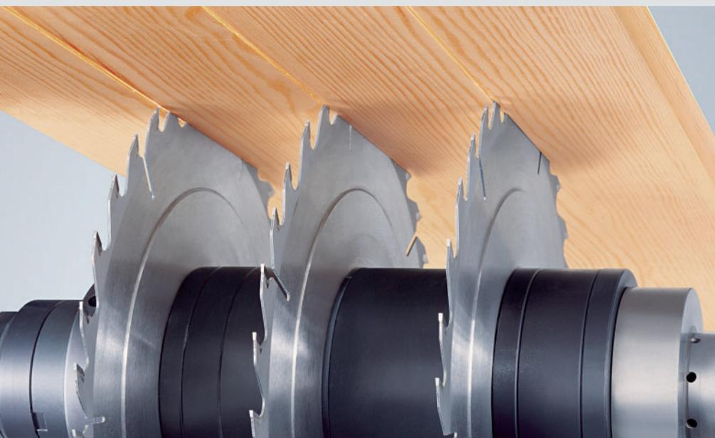
¿Por qué tomar con la mano tres veces una pieza de trabajo? El aserrar con la Hydromat significa realizar varios pasos de producción en una sola operación! Y, usted saca doble provecho: por un lado la enorme velocidad de producción y, por el otro, el elevado grado de precisión en la elaboración. Las elevadas potencias de los motores permiten trabajar con muchas sierras o con hojas de sierra de gran altura. Los trabajos de aserrado contribuyen a incrementar la capacidad productiva de su taller.
