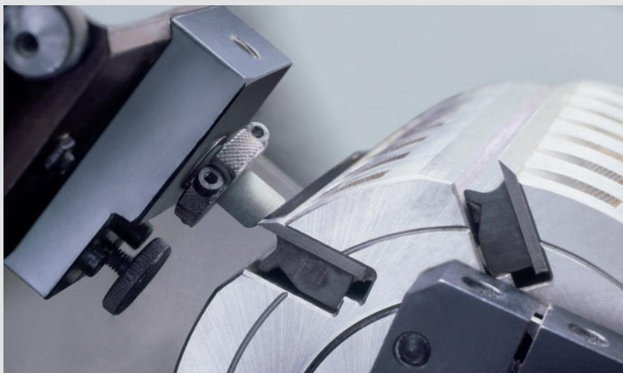
**Jointer perfilado automático y mandado a distancia con aproximación automática de la piedra.**
