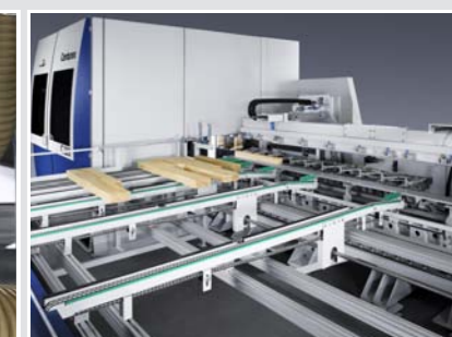
Automatización de entrada y salida para la fabricación con menos operarios
