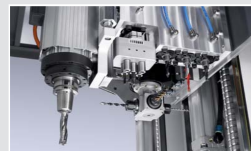
Combinación de cabezal de taladrado con varias salidas horizontales/verticales y fresa vertical
