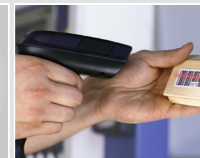
Identificación de las piezas de trabajo mediante código de barras
