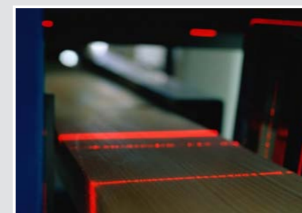
Fiabilidad de proceso mediante medición de la pieza bruta y vigilancia para evitar colisiones
