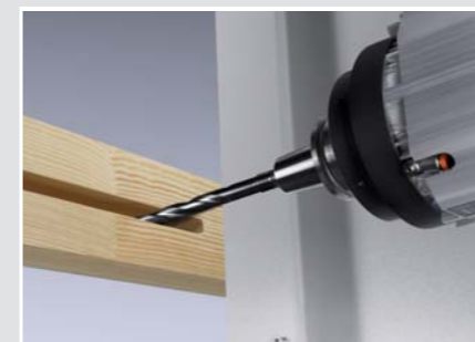
Agregado de fresado horizontal para el fresado de zonas amplias como para cerraduras
