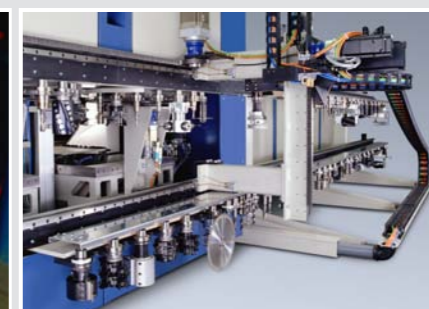
Almacenes de herramientas con hasta 390 soportes para la fabricación de sus perfiles
