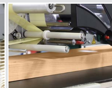
Identificación de las piezas de trabajo mediante láser, fresa o impresora
