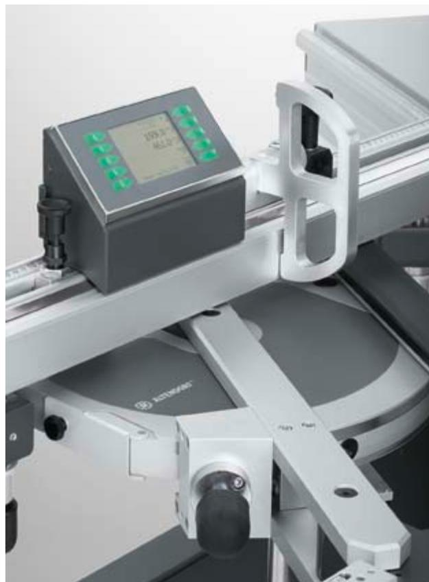
**DIGIT L.** Para el ajuste de la medida longitudinal con una exactitud de 1/10 mm. La pantalla muestra todas las medidas ajustadas de los registros. El sistema se calibra de una sola vez a través de la unidad central de medición y visualización. Con compensación longitudinal manual integrada. Incluye dos topes-guía de volteo único con ajuste de precisión y dos potentes baterías con cargador.
