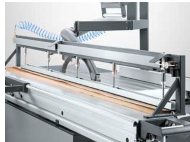
**Viga sometida a presión neumática.** Ideal para sujetar con firmeza piezas con un grosor de hasta 80 mm y especialmente útil para materiales largos y delgados, como chapas de madera. Está dividida en dos partes y se pueden guiar por separado. Requiere acometida neumática de 6 bar.
