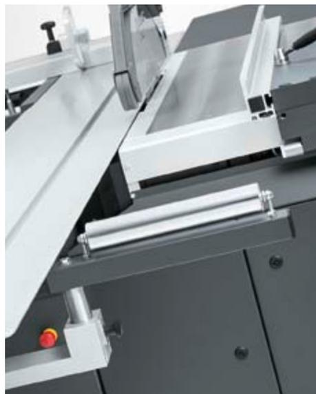
**Rodillo de apoyo delantero.** El rodillo de apoyo delantero, con una anchura de 300 mm, resulta de gran utilidad para cortar piezas largas en el tope-guía paralelo. Se puede posicionar con una empuñadura aprox. 90° debajo del carro de rodillos dobles (longitud mínima 3000 mm).
