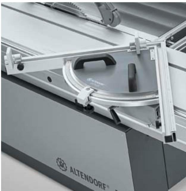
**Tope-guía de inglete doble DUPLEX.** Los tope-guía DUPLEX permiten ajustar ángulos de corte de 0 a 90° con gran rapidez y precisión y sin escalonamiento. A 45° pueden cortarse ingletes a ambos lados de la pieza sin necesidad de ajustar los dos tope-guía. El ajuste de la medida se realiza mediante lupa, escala graduada y escala para la compensación longitudinal. Todas las variantes del DUPLEX pueden posicionarse perfectamente a lo largo de todo el carro.
