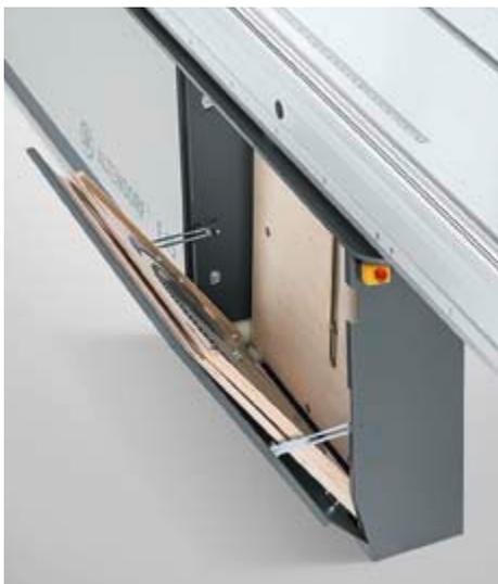
**Caja de herramientas.** La práctica caja de herramientas es una carcasa abatible en la que se pueden mantener a mano hasta seis portaherramientas (diámetro de la hoja de sierra máx. 550 mm). En el suministro se incluyen cuatro portaherramientas. Para poder utilizar esta opción se requiere una longitud mínima del carro de rodillos dobles de 3 000 mm.
