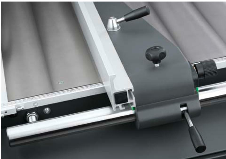
**Tope-guía paralelo con ajuste manual de precisión.** El tope-guía se regula con facilidad y se puede graduar manualmente con gran exactitud gracias al ajuste de precisión. El tope-guía adquiere su suavidad de marcha a través del sistema de barras redondas con cromado duro. A la hora de seccionar planchas de gran tamaño, el tope-guía se puede abatir debajo de la superficie de la mesa mediante una empuñadura.
