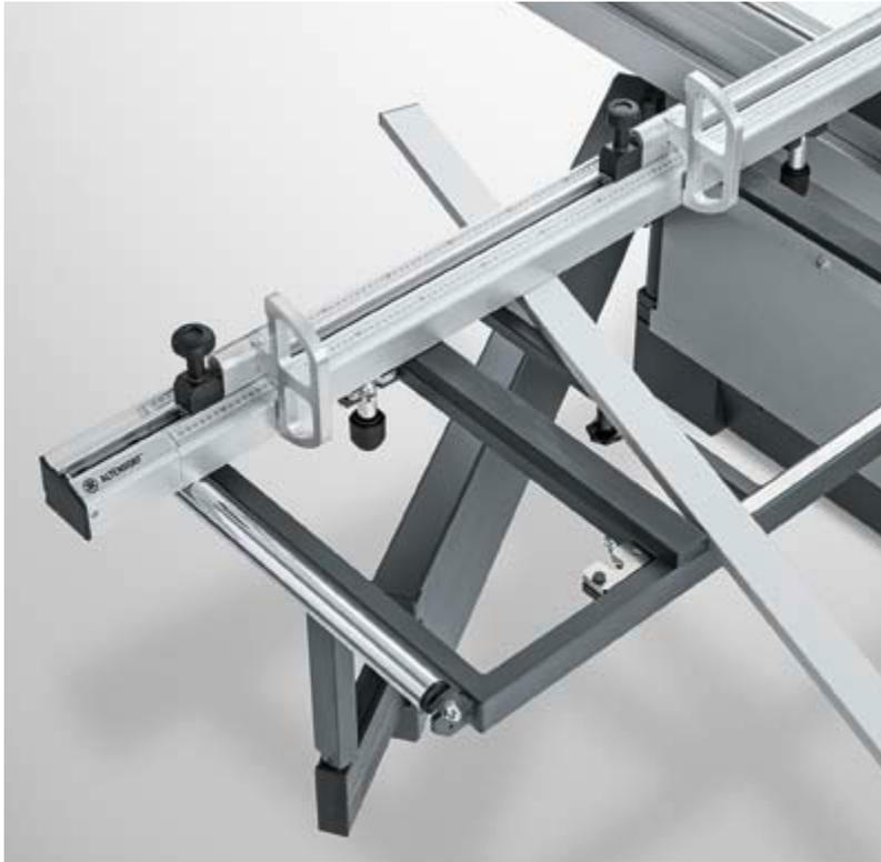
**Tope-guía angular con posición fija de 90°.** El tope-guía angular con posición fija de 90° es un asistente diario para los cortes de alta precisión de piezas de diversas longitudes y formatos. El tope-guía puede desplazarse fácilmente sin necesidad de elevarlo. Incluye dos topes-guía de volteo único.
