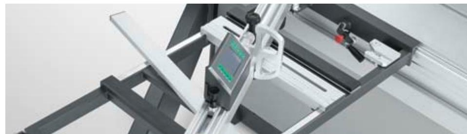
**DIGIT L.** para el ajuste de la medida longitudinal con una exactitud de 1/10mm. La pantalla muestra todas las medidas ajustadas de los registros. El sistema se calibra de una sola vez a través de la unidad central de medición y visualización. Incluye dos topes-guía de volteo único con ajuste de precisión, cargador y dos potentes baterías.
