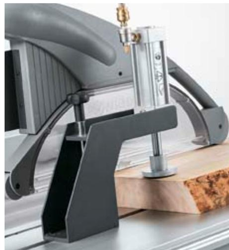
**Tensor rápido neumático.** Fija el apoyo de la pieza sobre el carro de rodillos dobles. Con mando por control remoto, el tensor rápido neumático genera una fuerza tensora de un máximo de 1000 N. La pieza queda fijamente sujeta en el tope-guía angular. Se pueden fijar piezas hasta un máximo de 170 mm de grosor. Se suministra con uno o con dos dispositivos de sujeción. Acometida neumática (6 bar) a cargo del cliente.
